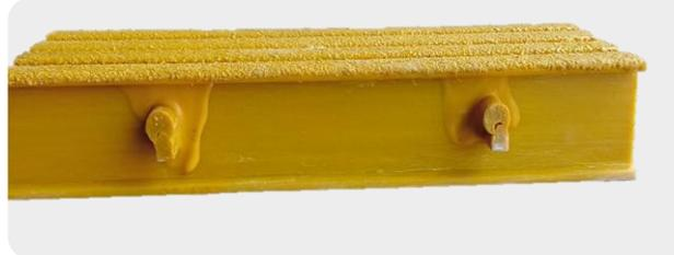
La Rejilla Pultruida PLAREMESA® PLA-T1720 es manufacturada por medio de modernos procesos de pultrusión con resinas isoftálicas premium y resinas viniléster de última generación y reforzada con filamentos de fibra de vidrio. Cuenta con una composición en su polímero de 70% vidrio - 30% resina ofrece una gran dureza y excelente resistencia mecánica unidireccional.
